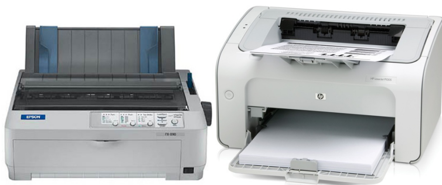
Slika 1.21. Matrični i laserski štampači
