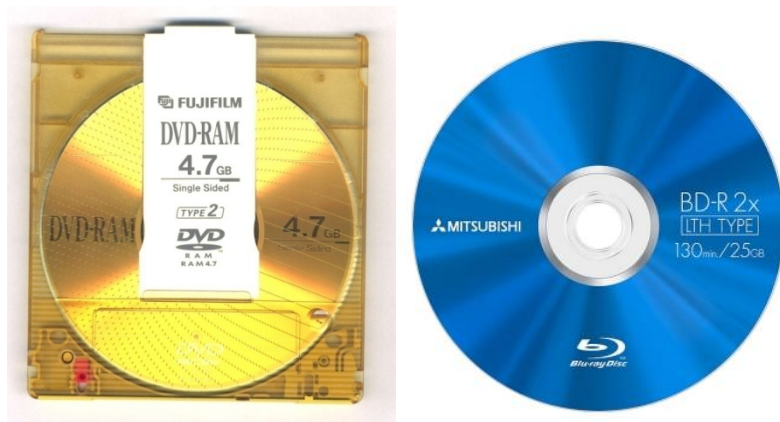
Slika 1.27. DVD i Blue-ray optički diskovi
