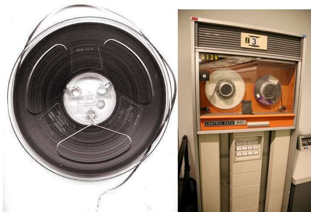
Slika 1.25. Magnetna traka u vidu kalema i kasete
