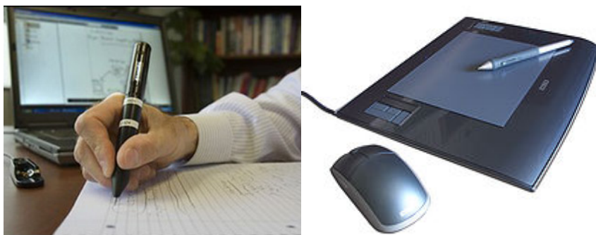
Slika 1.15. Olovka digitajzer i grafička bilježnica
