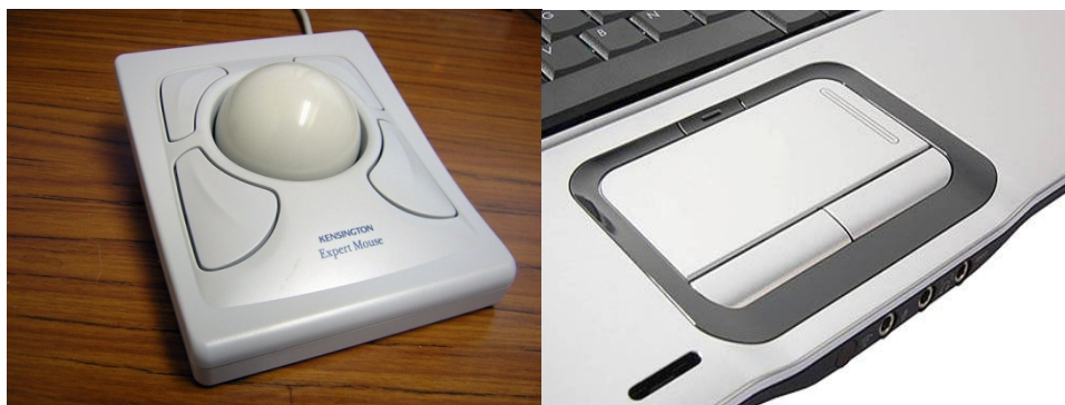
Slika 1.13. Trackball i touchpad
