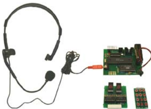
Slika 1.16. Uređaj za digitalizovanje govora
